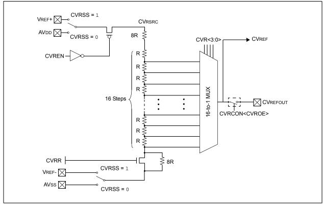
REGISTER 23-1: CVRCON: COMPARATOR VOLTAGE REFERENCE CONTROL REGISTER
