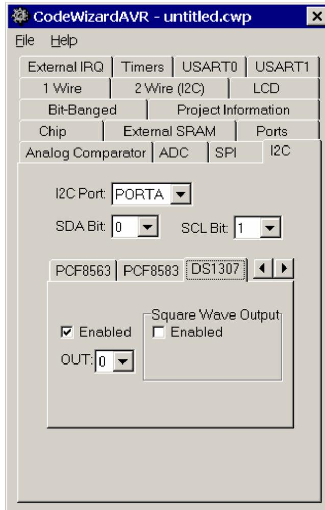
The DS1307 device is accessed through the **Maxim/Dallas Semiconductor DS1307 Real Time Clock Functions**.
